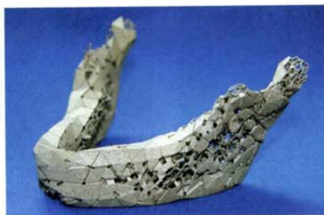
Kieferknochen-Implantat aus Metallpulver gebacken
