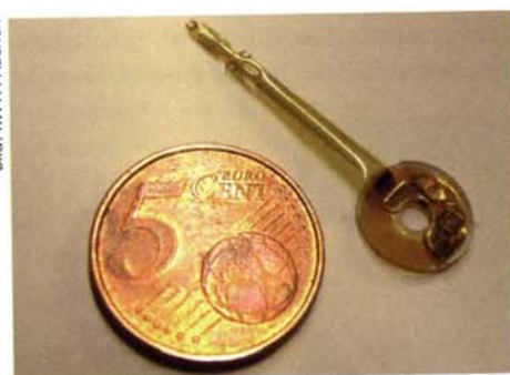
Drahtlose Sehprothese klein wie ein 5 Cent Stück
